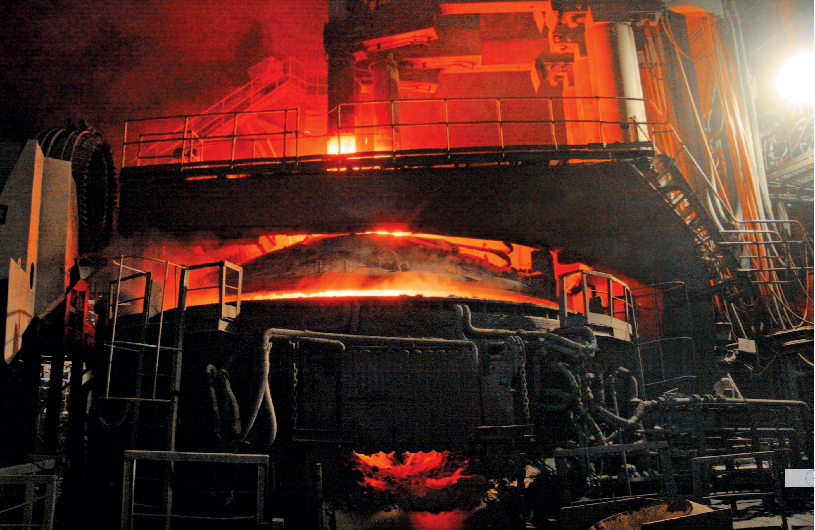
.....⊙ Дуговая сталеплавильная печь
